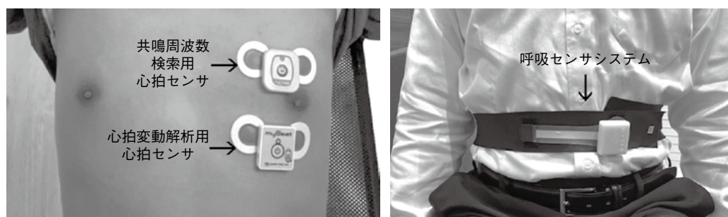
Fig. 3 センサ装着位置 (左図：心拍センサ, 右図：呼吸センサ)
